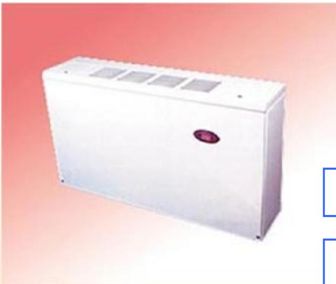
❾ چنانچه از فن کویل به عنوان وسیله سرمایشی استفاده شود، امکان تقطیر رطوبت هوا روی کویلها وجود خواهد داشت. آب حاصل از تقطیر در سینی زیر کویلها جمع شده و از طریق لوله تخلیه خارج می‌گردد. قطر لوله تخلیه اغلب  $\frac{3}{4}$ " و جنس آن از فولاد گالوانیزه است.
