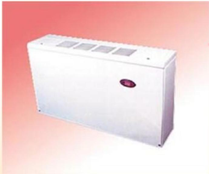
§ انتخاب فن کویل با توجه به بار گرمایشی-سرماشی و با مراجعه به کاتالوگ سازنده صورت می‌گیرد. از آنجا که اختلاف دمای بین آب و محیط در گرمایش تقریباً دو برابر سرماش است، ظرفیت گرمایشی فن کویل‌ها به مراتب بیش از ظرفیت سرماشی آنها بوده و لذا اغلب فن کویل برای بار برودتی انتخاب شده و برای بار گرمایی چک می‌شود.
